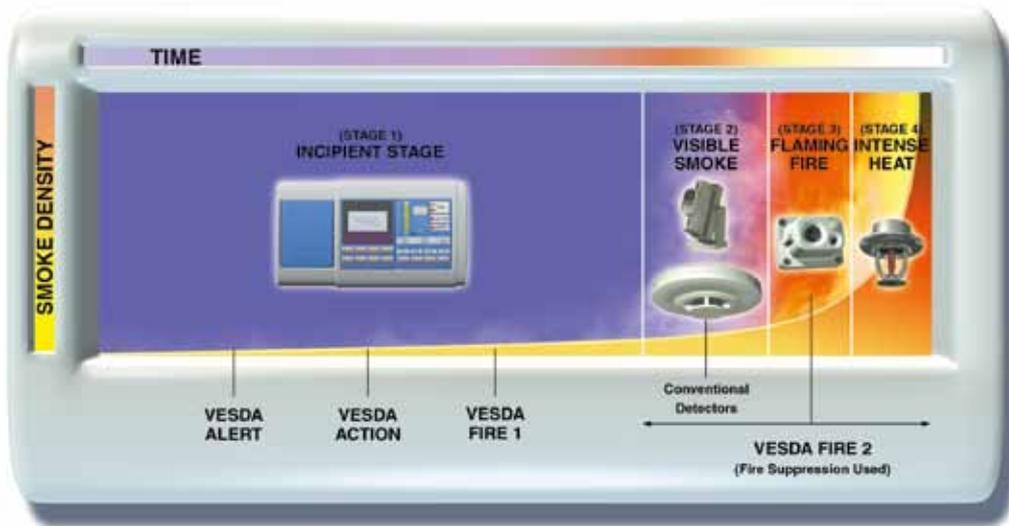
这个示意图显示了火灾随时间而发展的进程。请注意，在图示窗口中，火灾的初级阶段具有很宽的时间范围，它给人们提供了大量机会去探测和控制火灾的蔓延。用户可以对 VESDA 进行设置，使它在火灾的初级阶段发出多级报警，也可以将 VESDA 设置为在火灾的后续阶段再发出额外的报警（火警2）。这是 VESDA 独一无二的特性，它得益于其极宽的灵敏度范围，使探测器能够对火灾发展的整个过程进行监控。
